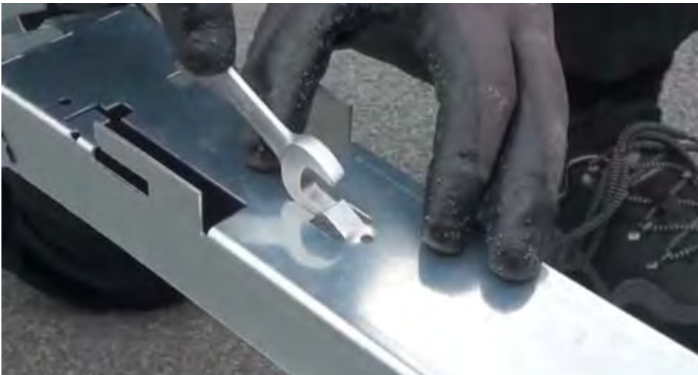
Mittlere Führungslaschen des Ständerelements oben hochbiegen (ca. 45 Grad).
