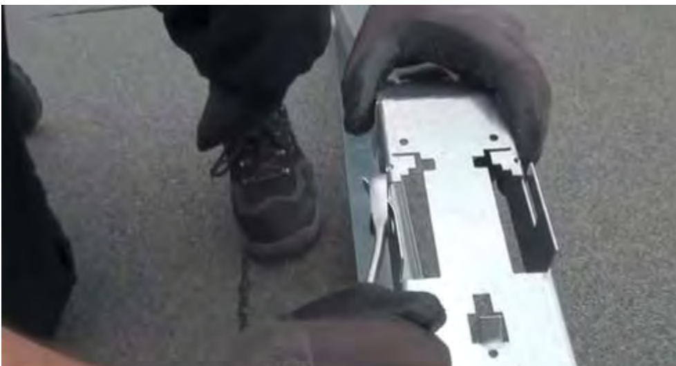
Modulhaltelaschen 45 Grad nach außen biegen (eine zu geringe Biegung führt dazu, dass das Modul nicht sicher gehalten wird oder dass sich das Modul nicht komplett einschieben lässt).
